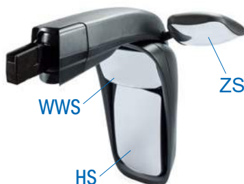
Spiegel mit HS, WWS und ZS (links) mirror with HS, WWS and ZS (left)
